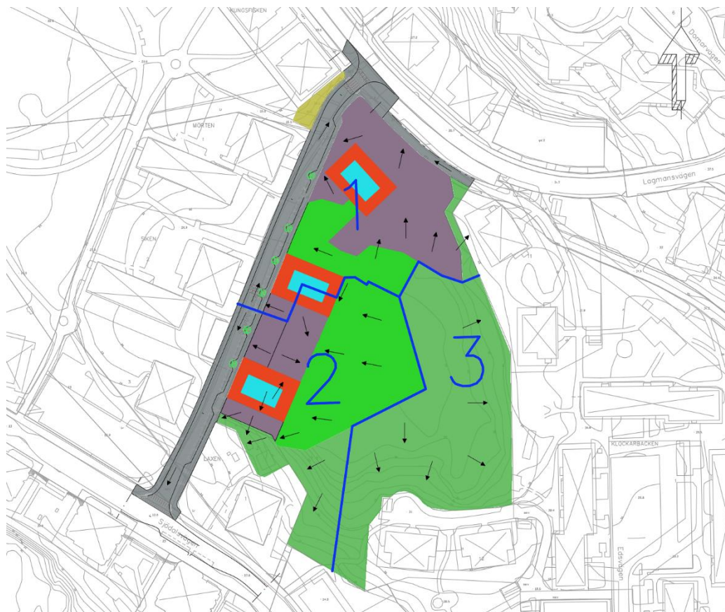
Figur 17. Avrinning vid skyfall efter exploatering. Den blå linjen representerar en naturlig vattendelare som delar området i tre avrinningsområden vid skyfall. I område 1 rinner vattnet mot norra Södalsbacken och Klockarvägen, i område 2 rinner vattnet mot södra Södalsbacken och Södalsvägen och i område 3 rinner vattnet mot sydöst.
